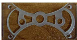
Pont de roue en saphir (horlogerie)
