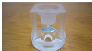
Réplique d'injecteur en quartz (automobile)
