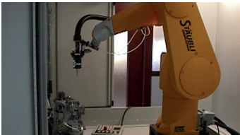
Cellule de soudage laser
