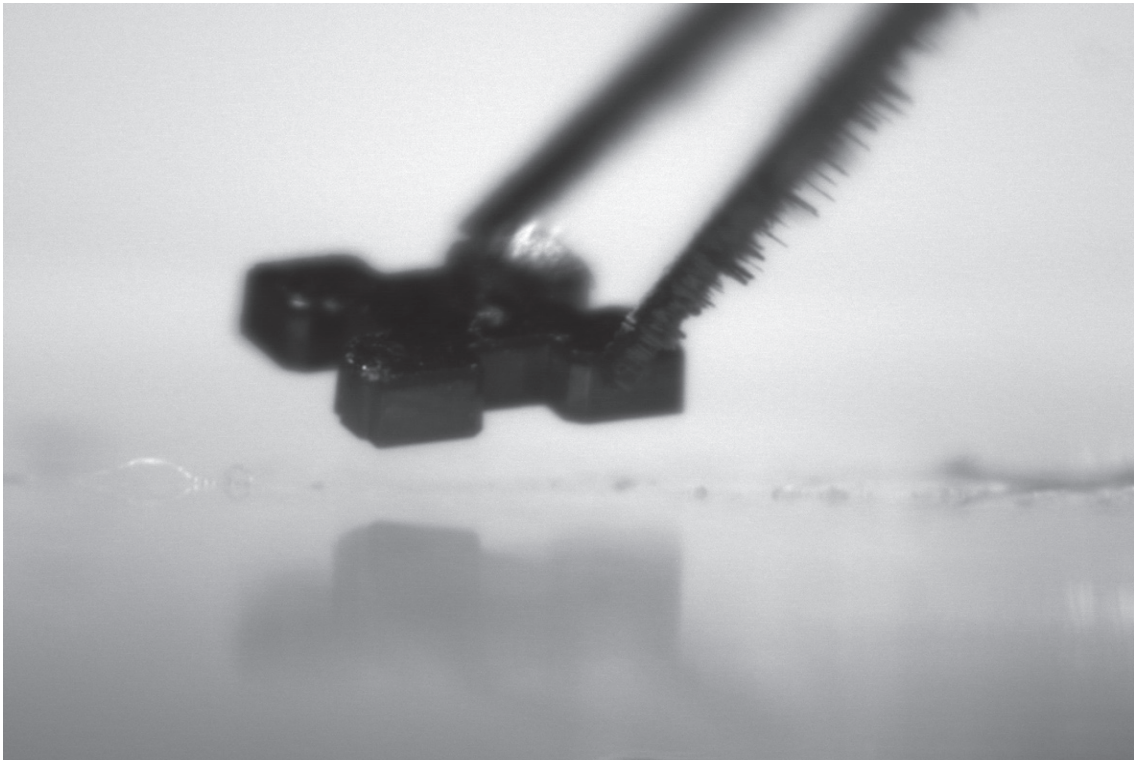
Une des stations possibles : la micromanipulation d'un composant de 400 µm par 400 µm avec un préhenseur issu du département AS2M de l'Institut FEMTO-ST
